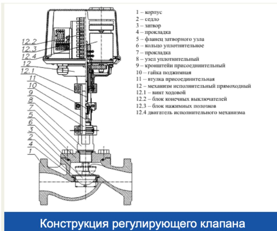
Нюансы регулирующего устройства, которое применяется для контроля рабочей среды, определяются типом рабочего механизма и способом фиксации арматуры к бытовому или промышленному трубопроводу. Среднестатистический регулировочный клапан состоит из следующих элементов:
